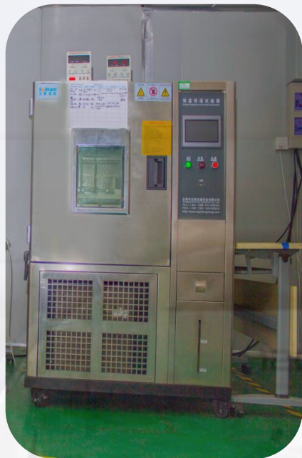
设备名称：恒温恒湿箱 Name: constant temperature and humidity chamber 型号/model: 正航仪器/ZH-TH-150D 温度范围：-40℃~ + 90℃ 温度波动度：±1.0℃ 温度均匀度：±2.0℃
