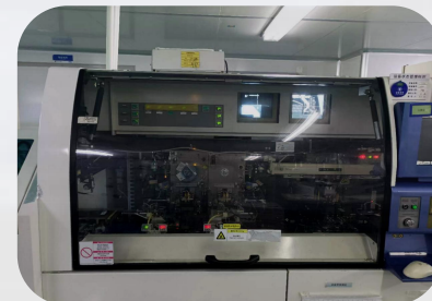
3. 芯片绑定到玻璃上 COG Bonding \pm 2\mu\text{m}
