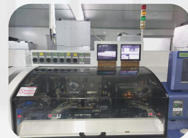
4. 柔性电路板绑定到玻璃上 FOG Bonding \pm 5\mu\text{m}
