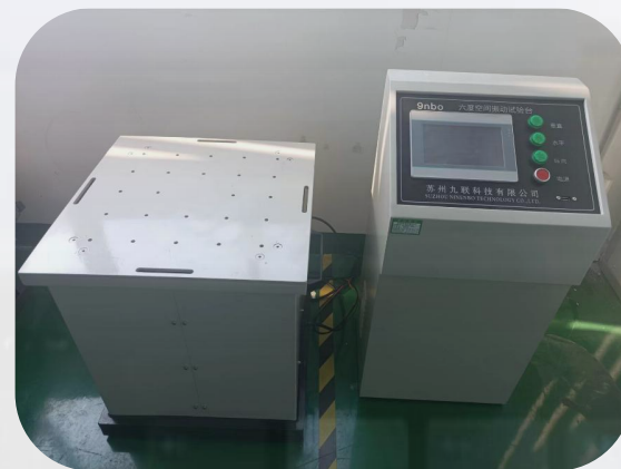
设备名称：震动试验台 Name: vibration test bench 型号/model: NEV-XTP
