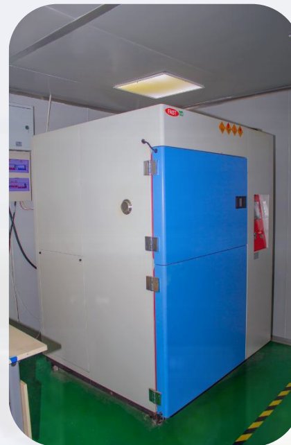
设备名称：三槽式冷热冲击箱 Name: Three groove cold and thermal shock test chamber 型号/model: 华氏特/TS-80L 温度波动度：±1.0℃ 温度均匀度：±2.0℃
