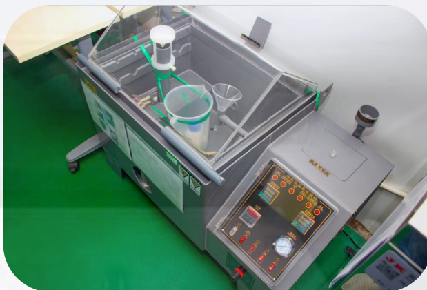
设备名称：盐雾试验机 Name: salt spray test machine 型号/model: 乐迪仪器 ( LD-60A )
